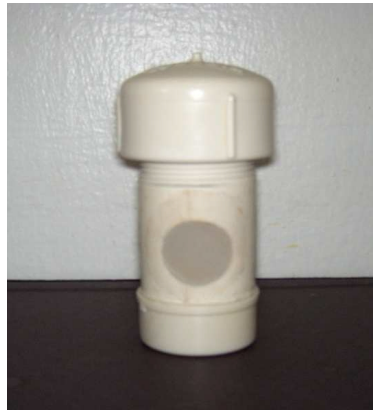
Figura 1: Câmara de ensaio in situ SUNDFELD (2010).
