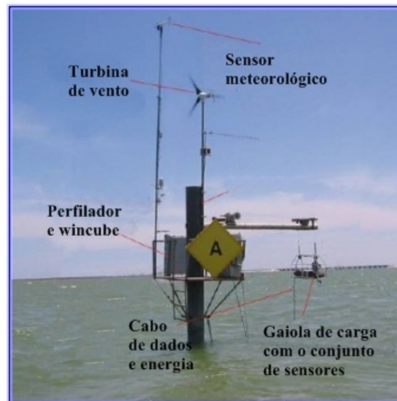
Figura 6: Representação do sistema robótico fixo na Baía Corpus Christi. Fonte: Islam et al. (2010).
