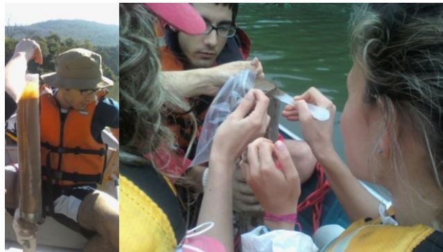
Figura 5: Testemunho da represa Paiva Castro e o fatiamento e armazenamento em saco hermeticamente fechado.
