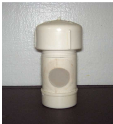
Figura 1: Câmara de ensaio in situ SUNDFELD (2010).
