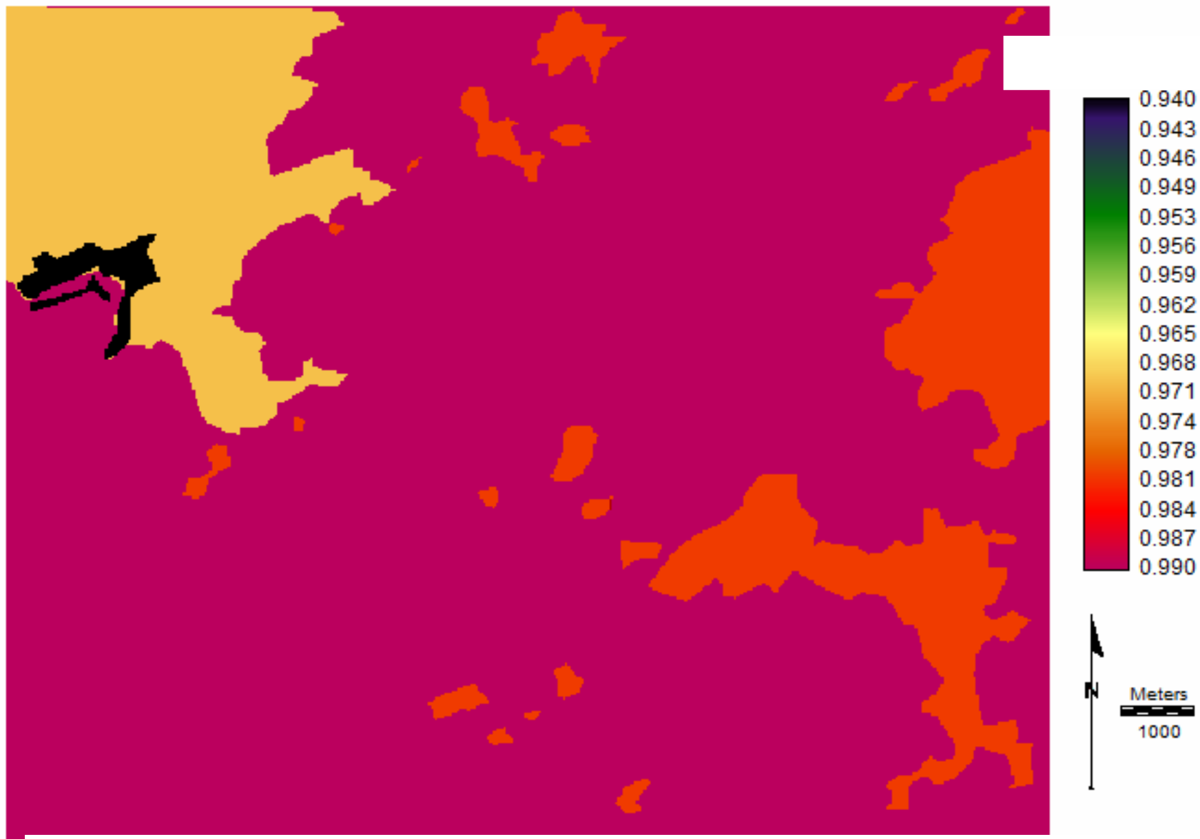
Figura 6. Imagem dos vetores reclassificados de acordo com sua emissividade , para gerar imagem de temperatura real.
