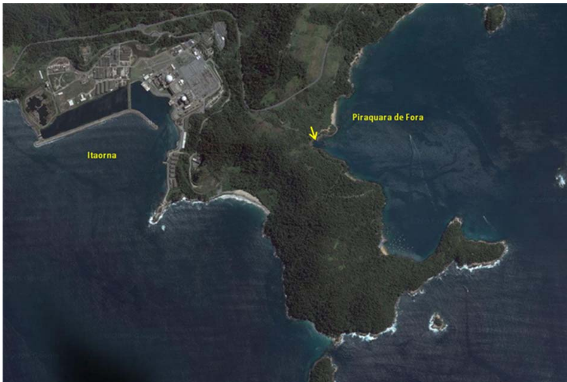
Figura 3. Região da Central Nuclear de Angra dos Reis, evidenciando a região de Itaorna (captação da água de refrigeração) e do Saco de Piraquara de Fora, onde a água do circuito terciário é despejada. O ponto de descarga é indicado pela seta amarela. Observa-se grande turbulência na água do mar a partir deste ponto.
