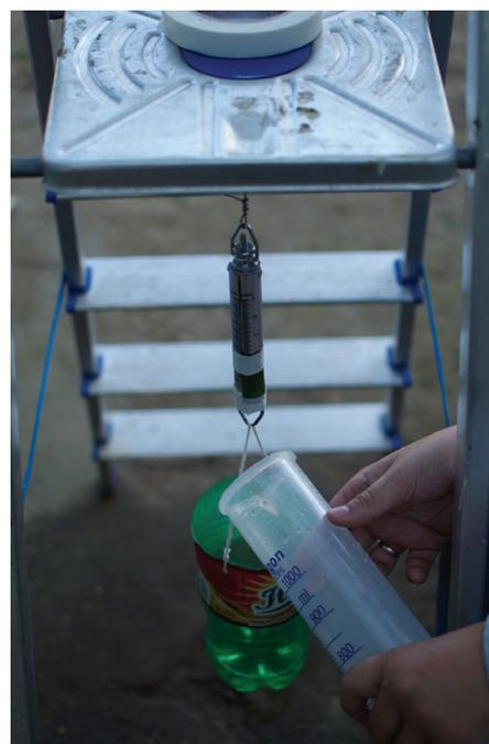
Figura 2. Equipamento utilizado para determinar o índice de resistência (IR) das folhas de *Cecropia pachystachya*. Acoplamos a tira retangular da folha (indicada pela seta) no dinamômetro e adicionamos água ao recipiente progressivamente até que a folha se rompesse.
